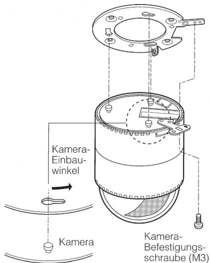
**Hinweis:** Wenn die Kamera von dem Kamera-Einbauwinkel abgenommen wird, die Kamera-Befestigungsschraube (M3) lösen und mit einem Schraubendreher nach oben drücken.
