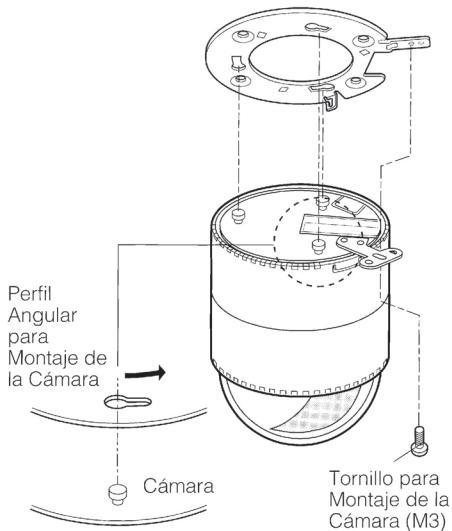
**Nota:** Cuando vaya a quitar la Cámara del Perfil Angular para Montaje de la Cámara, afloje el Tornillo para Fijación de la Cámara (M3) y empújela hacia arriba usando el destornillador.
