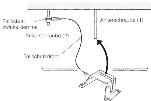
7. Eine Standard-Ankermutter an der Ankerschraube (1) anbringen, wie es in der Abbildung dargestellt ist.
