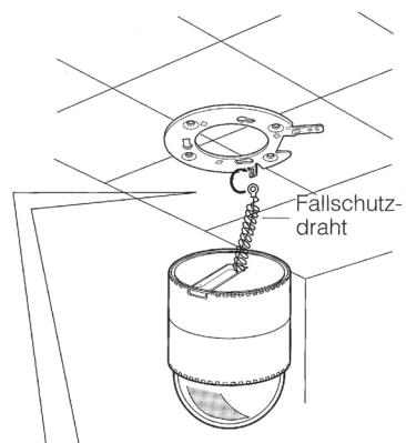
Unbedingt den Draht mit dem Fallschutz-draht-Befestigungswinkel ausrichten, wie es nachfolgend dargestellt ist.
