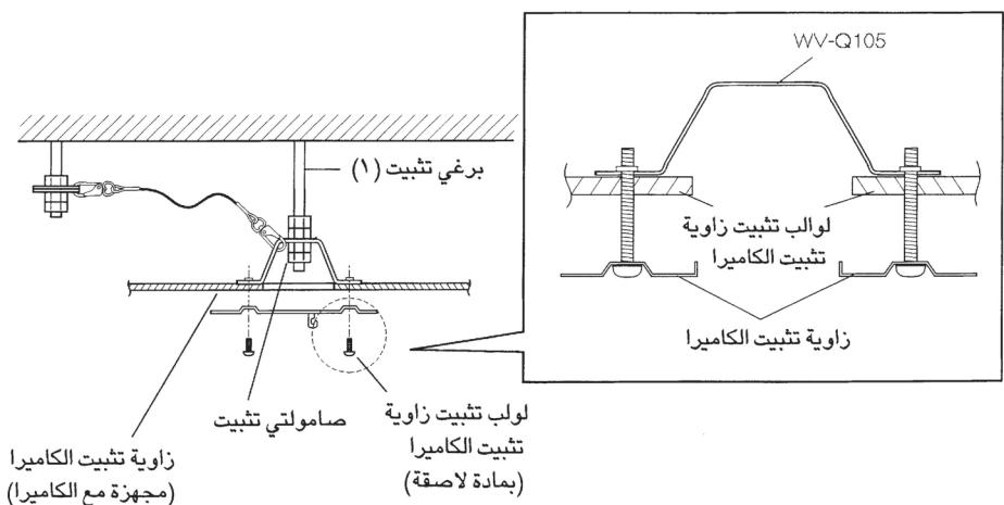
٢. ادفع برغي تثبيت قياسي (رقم ١ في الرسم) في الفتحة المركزية المعمولة في السقف كما مبين في الخطوة ١.
