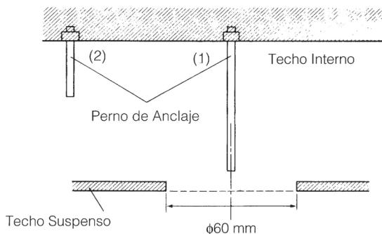
4. Sujete la Abrazadera de Perfil Angular para Prevención de Caída del Herraje de Fijación (suministrada) en el Perno de Anclaje (2) según los procedimientos descritos más abajo. Tenga siempre presente que la "Abrazadera en Forma de L" tiene el lado "1" y el lado "2", y necesita ser doblada manualmente en la posición adecuada durante su instalación para su colocación correcta.
