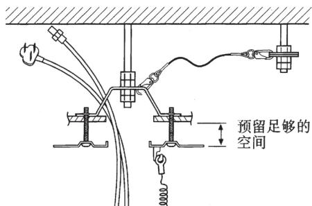
11. 将掉落保护弹簧悬挂在摄像机角度定位板上。
