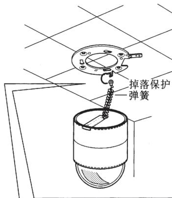
如图所示，务必让掉落保护弹簧与该弹簧的角度固定板相密合。
