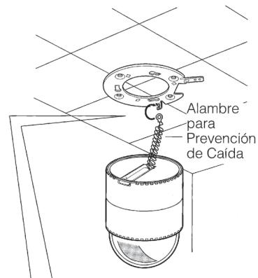
Asegúrese de acoplar el alambre con el Perfil Angular para Fijación del Alambre para Prevención de Caída como se muestra en la figura abajo
