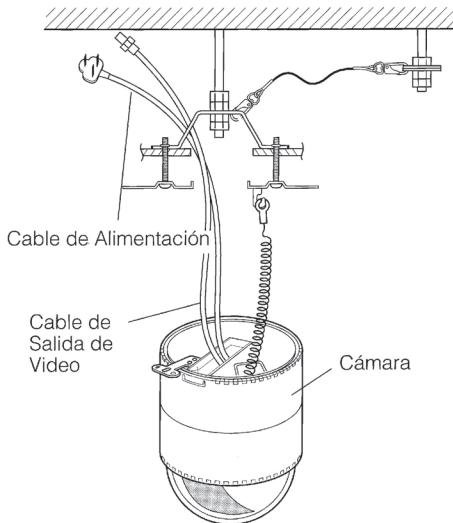
13. Apriete los cuatro Tornillos del Perfil Angular para Montaje de la Cámara.
