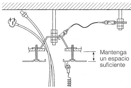
11. Cuelgue el Alambre para Prevención de Caída en el Perfil Angular para Montaje de la Cámara
