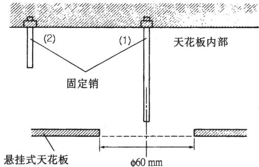
4. 按照下列步骤，将框架掉落保护角度夹（配件）连接于固定销（2）上。请注意“L型”夹有面“1”和面“2”之分，并且在安装时该夹必须能够被手动弯曲到正确的位置。
