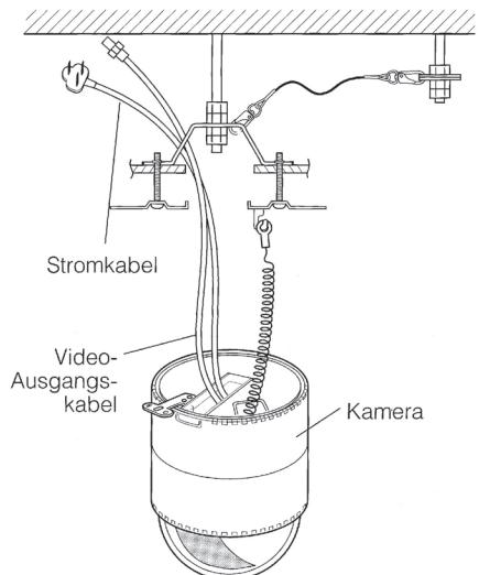
13. Die vier Kamera-Einbauwinkel-Befestigungsschrauben festziehene.
