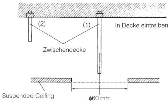
4. Die Halterungs-Fallschutzwinkelklemme (mitgeliefert) gemäß nachfolgender Schritte an der Ankerschraube (2) anbringen. Darauf achten, daß die "L-förmige" Klemme eine Seite "1" und eine Seite "2" aufweist und während der Installation von Hand in die richtige Position gebogen werden muß.
