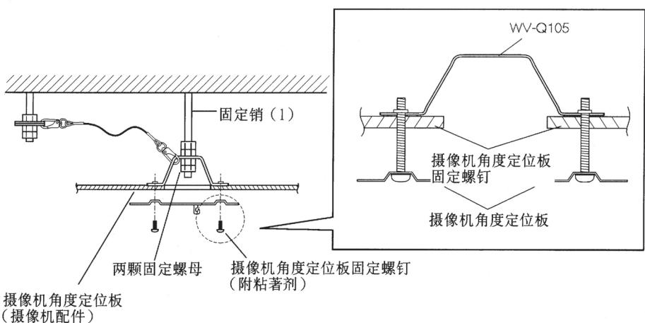
10. 利用四颗摄像机角度定位板固定螺钉，暂时将摄像机角度定位板（摄像机配件）固定于被连接著的框架上。
