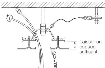
11. Accrocher le câble de prévention de chute de potence de fixation à la cornière de fixation de caméra vidéo.
