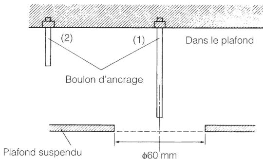
4. Fixer l'attache de cornière de prévention de chute de potence de fixation (fournie) au boulon d'ancrage (2) en procédant de la façon ci-après. À noter que l'attache en forme de L possède un côté "1" et un côté "2" de sorte qu'elle doit être pliée à la main pour être mise en place au cours des opérations d'installation pour que sa mise en place soit correctement faite.
