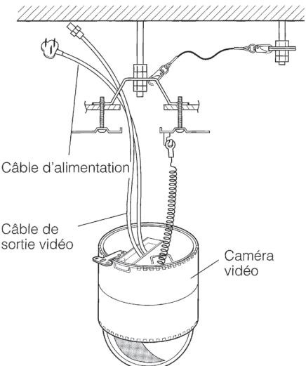
13. Bloquer les vis de fixation de cornière de fixation de caméra vidéo.
