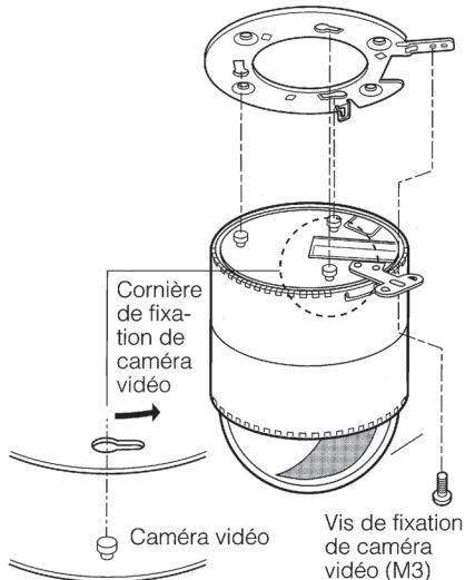
**Remarque:** Lorsque la caméra vidéo est retirée de la cornière de fixation de caméra vidéo, desserrer tout d'abord la vis de fixation de cornière de fixation de caméra vidéo (M3) et repousser vers le haut avec un tournevis.
