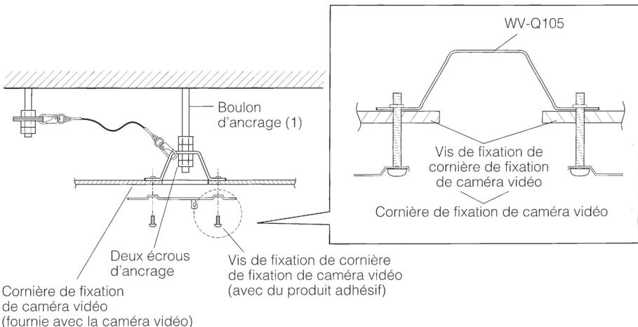
10. Installer provisoirement la cornière de fixation de caméra vidéo (fournie avec la caméra vidéo) sur cette potence de fixation de caméra vidéo avec les quatre vis de fixation de cornière de fixation de caméra vidéo.
