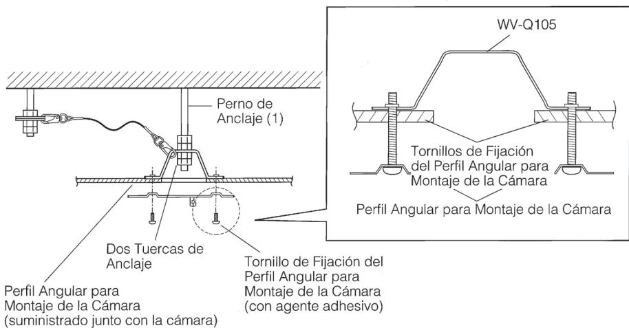
10. Monte el Perfil Angular para Montaje de la Cámara (suministrado junto con la cámara) provisionalmente en este herraje de montaje conectado, usando los cuatro Tornillos para Fijación del Perfil Angular para Montaje de la Cámara.
