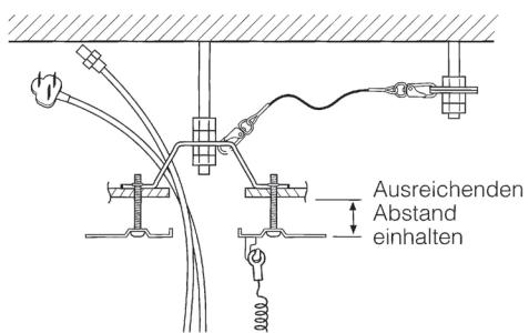
11. Den Fallschutzdraht am Kamera-Einbauwinkel einhängen.
