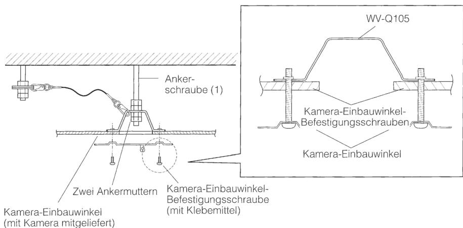
10. Den Kamera-Einbauwinkel (mitgeliefert mit der Kamera) vorübergehend an der gesicherten Halterung anbringen, indem die vier Kamera-Einbauwinkel-Befestigungsschrauben verwendet werden.
