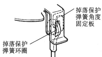
12. 将摄像机的电线穿过摄像机角度定位板内的槽孔。
